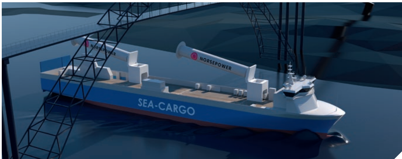
Sea-Cargo satser på seilskip som en del av fremtiden og installerer to rotorseil og batteripakke på Ro-Ro skipet SC «Connector» senere i år.
