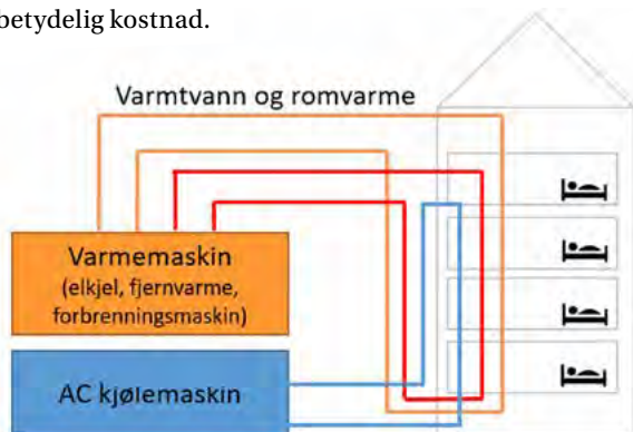
Figur 1: Illustrasjon av typisk termisk system for oppvarming og kjøling i hotell.
